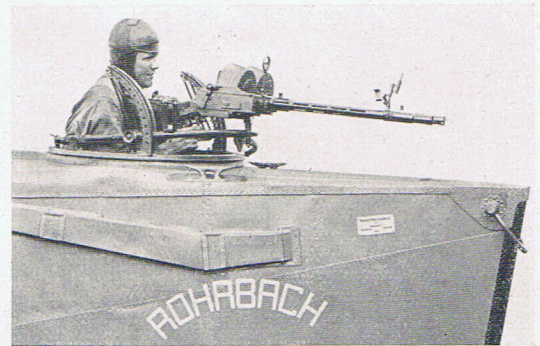
Fig. 21. Installation de mitrailleuse jumelée
